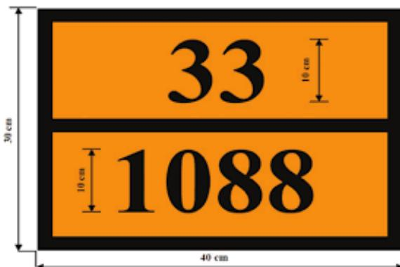
Slika 15. Ploča za označavanje vozila
