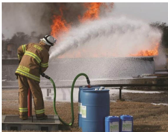
Sl. 20. Nabacivanje zračne pjene [16]
