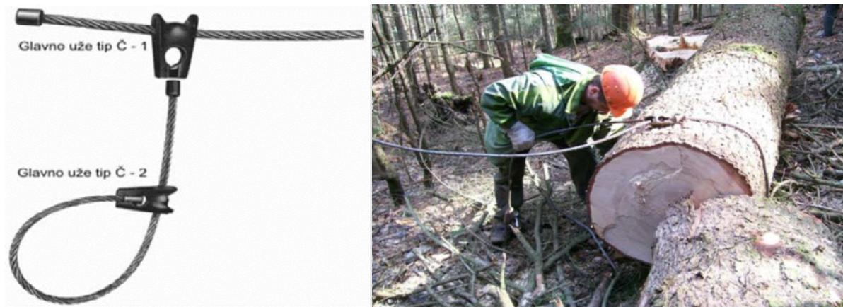
Slika 10. Prikaz glavnog vučnog užeta i čelične omče
