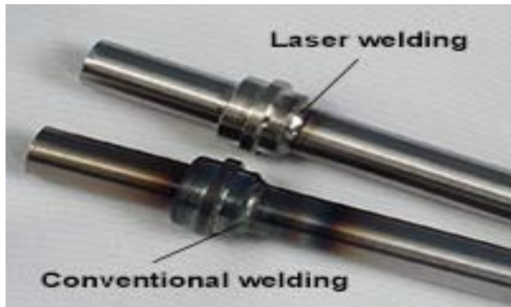
Sl. 23. Usporedba laserskog i normalnog vara [37]
