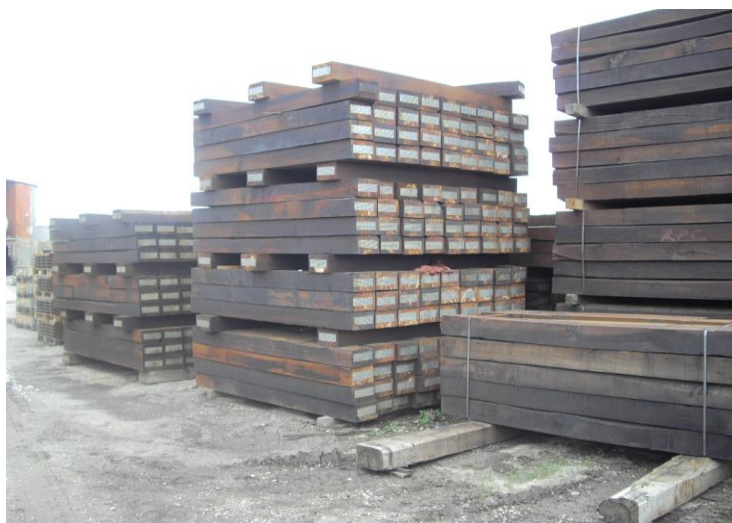
Sl.17. Skladišteni i impregnirani pragovi
