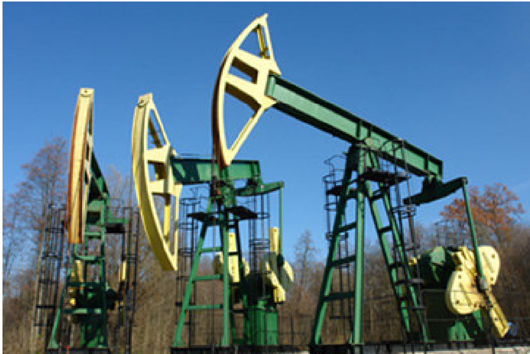
Slika 3. Podizanje nafte dubinskim sisaljkaama [6]
