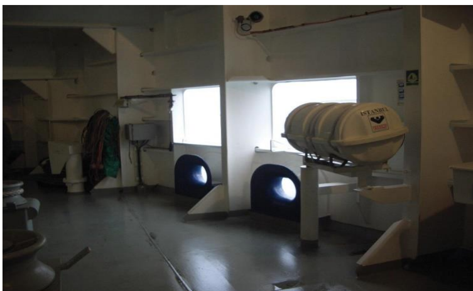
Slika 20. Splav za spašavanje na pramcu [17]
