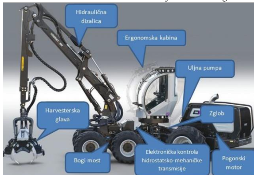
Slika 23. Dijelovi harvesteri Dijelovi harvesteri
