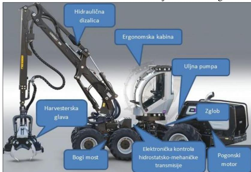
Slika 23. Dijelovi harvestera Dijelovi harvestera
