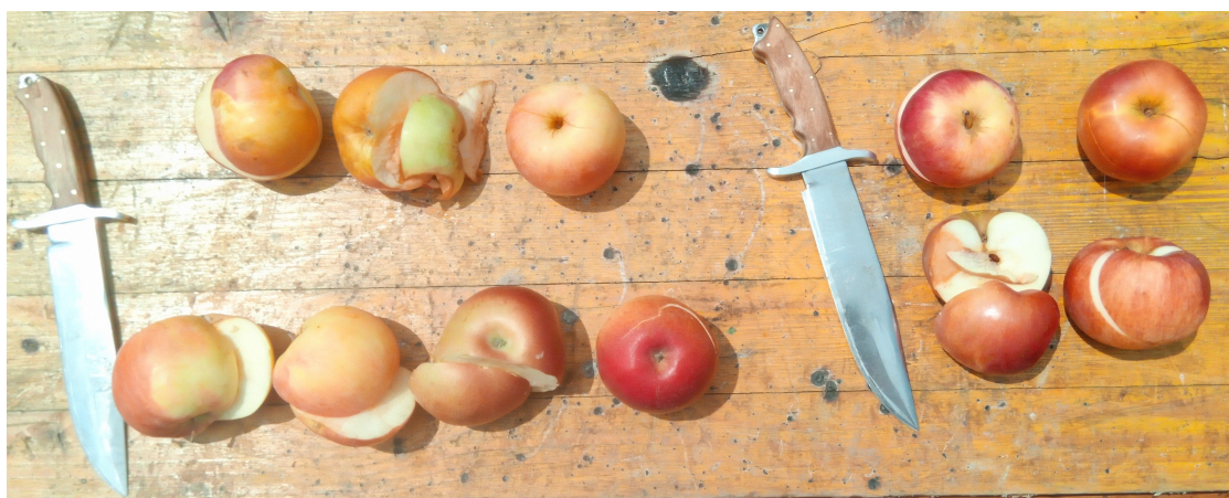
Slika 72 Ukupni rezultat razrezanih jabuka, lijevo je PER 1 (opružni čelik), desno osikro 4 (alatni čelik)
