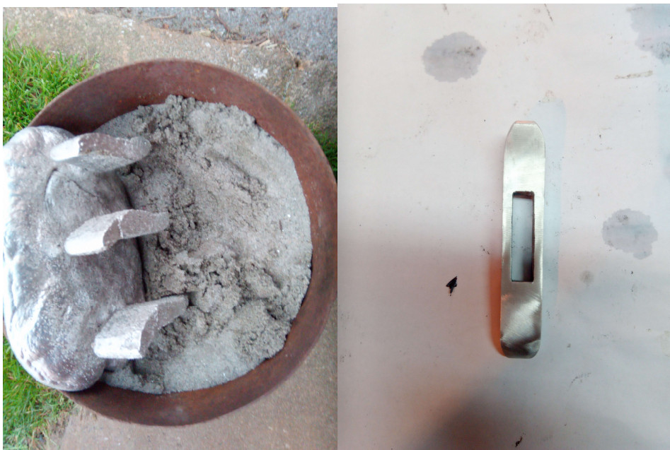
Slika 64 Odljevak i finalni oblik nakon brušenja
