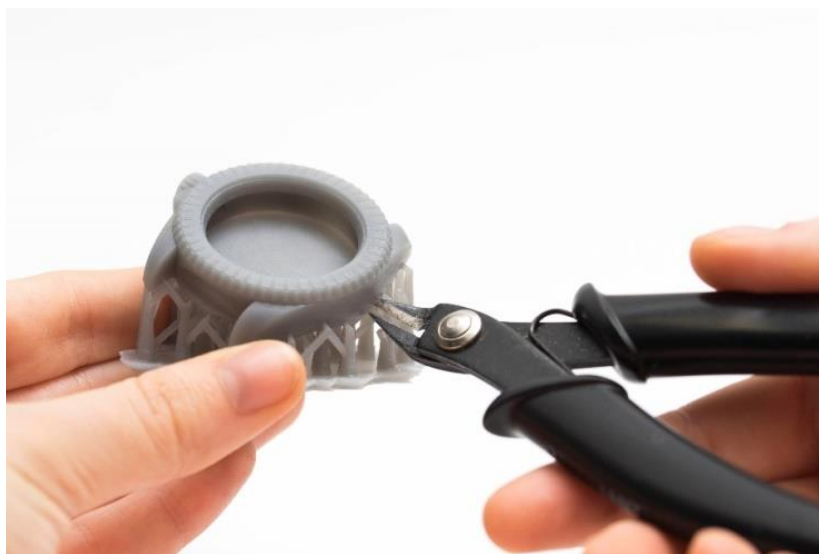
Slika 7. Uklanjanje potporne strukture (SLA). [7]
