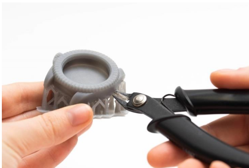
Slika 7. Uklanjanje potporne strukture (SLA). [7]
