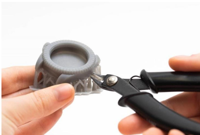
Slika 7. Uklanjanje potporne strukture (SLA). [7]
