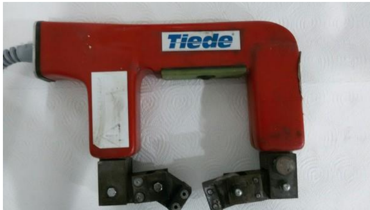
Slika 59: Magnetski jaram TIEDE TWM 230 A [6]
