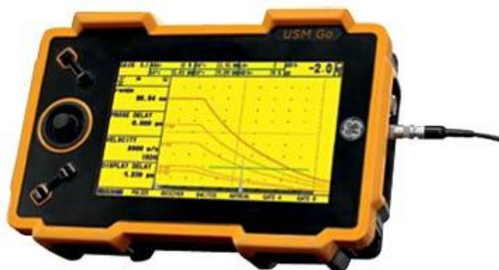
Slika 62: Ultrazvučni uređaj USM GO [9]
