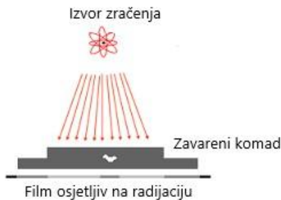
Slika 35. Shema radiografske metode [29]
