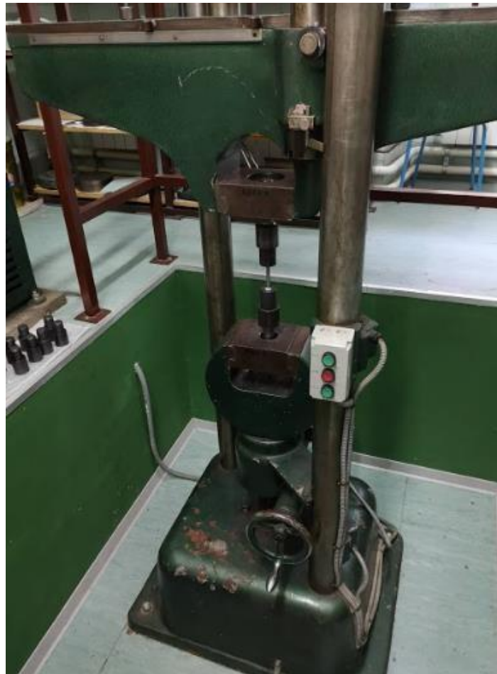
Slika 30: Kidalica proizvođača Otto Wolpert Werke
