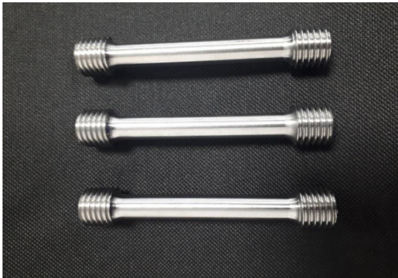
Slika 35. Priprema epruveta za proces nitriranja
