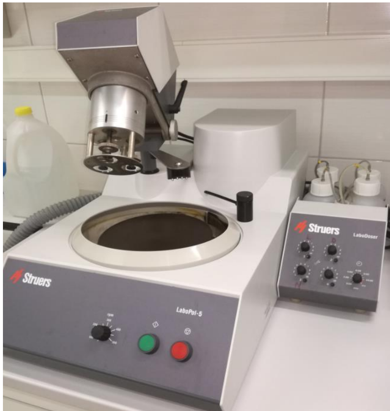
Slika 45. Uređaj za poliranje Struers, modela LoboPol-5
