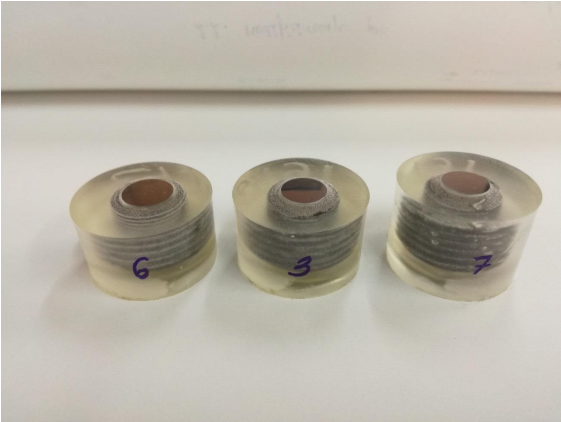
Slika 46. Uzorci pripremljeni za metalografski snimak (uzorci 3, 6 i 7)
