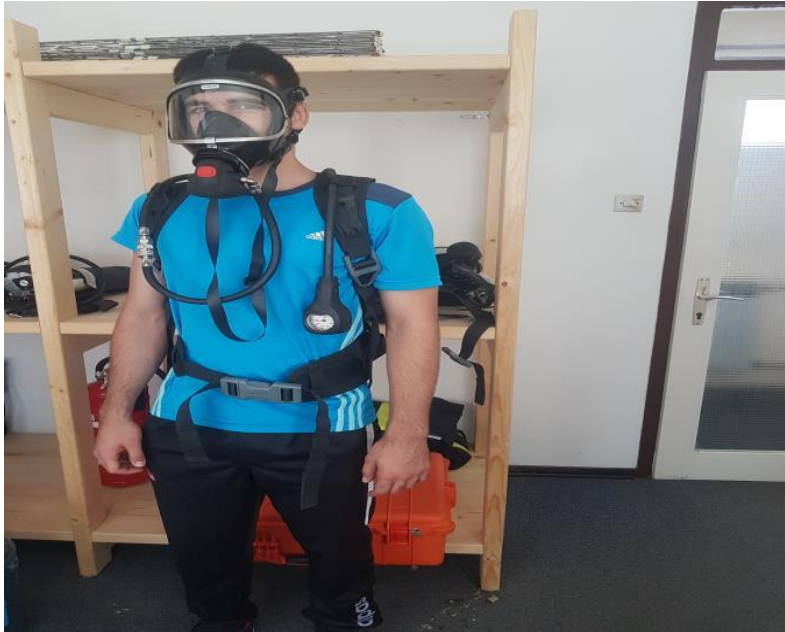
Slika 38. Izgled uređaja PSS 3000 na čovjeku
