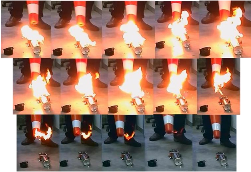
Slika 31. Vakuum efekt usmjerivača zvuka.[15]
