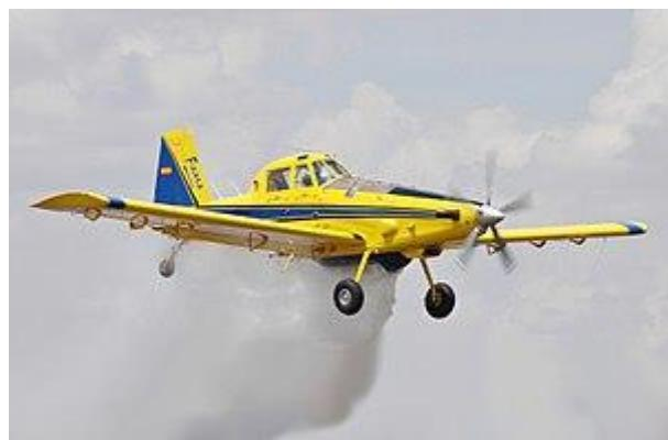
Slika 22. Protupožarni zrakoplov AirTractor AT 802 F [18]
