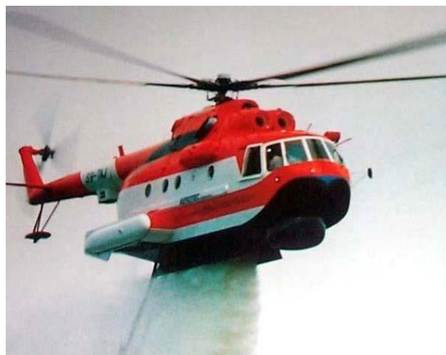
Slika 25. Helikopter Mi 8 MTV – I za gašenje sa stabilnim spremnikom [21]
