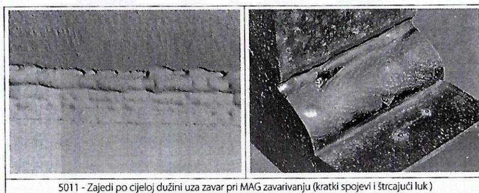
Slika 20. Pogreške oblika zavara-zajedi
