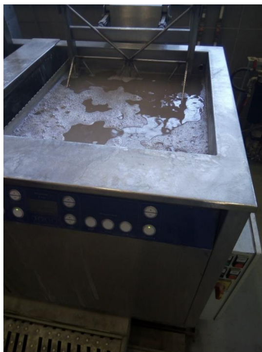
Slika 30. Ultrazvučno pranje uzoraka zavara u deterđentu
