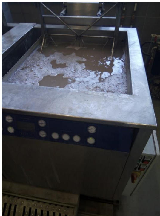
Slika 30. Ultrazvučno pranje uzoraka zavara u deterđentu
