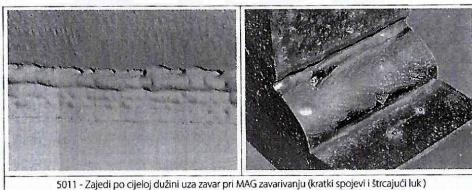
Slika 20. Pogreške oblika zavara-zajedi
