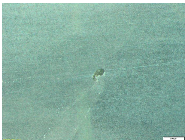
Slika 36. Plinski mjehurić-pora kuglastog oblika
