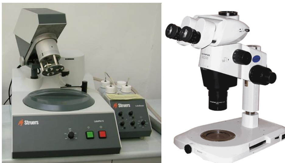
Slika 33. Uređaj za poliranje STRUERS LABOPOL-5 i mikroskop OLYMPUS SZX 10
