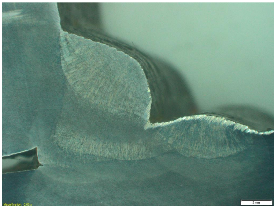
Slika 37. Kutni spoj jednostrano zavaren
