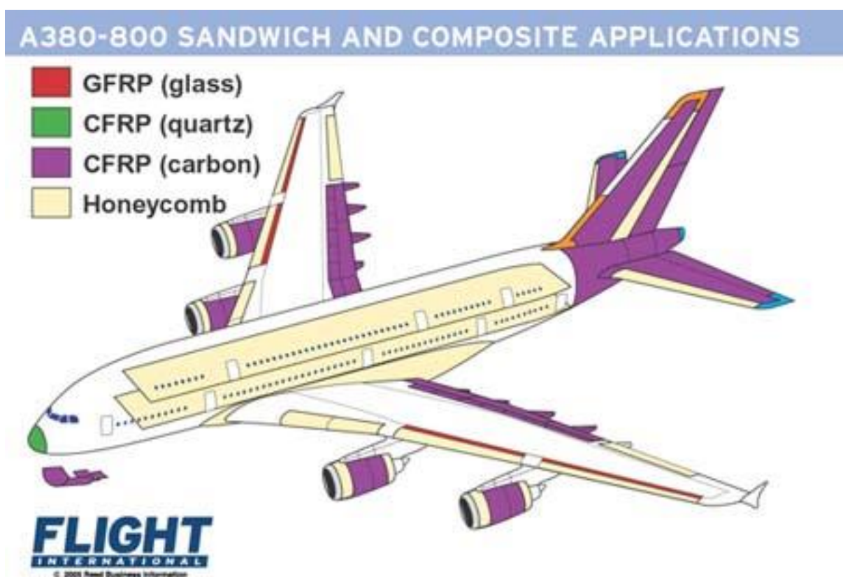
Slika 17. Prikaz upotrebe ugljičnih vlakana kod Airbus-a A380
