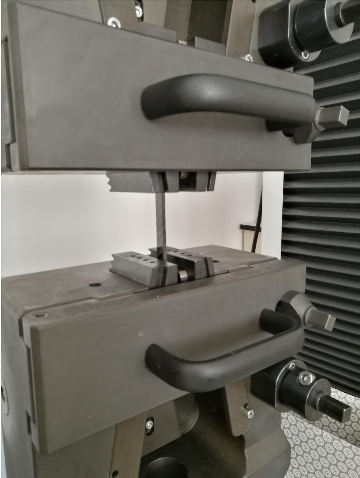
Slika 22. Epruveta postavljena u kidalicu
