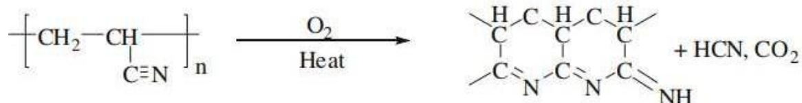
Slika 11. Kemijski spoj poliakrilonitrila kao osnovne sirovine za proizvodnju karbonskih vlakana
