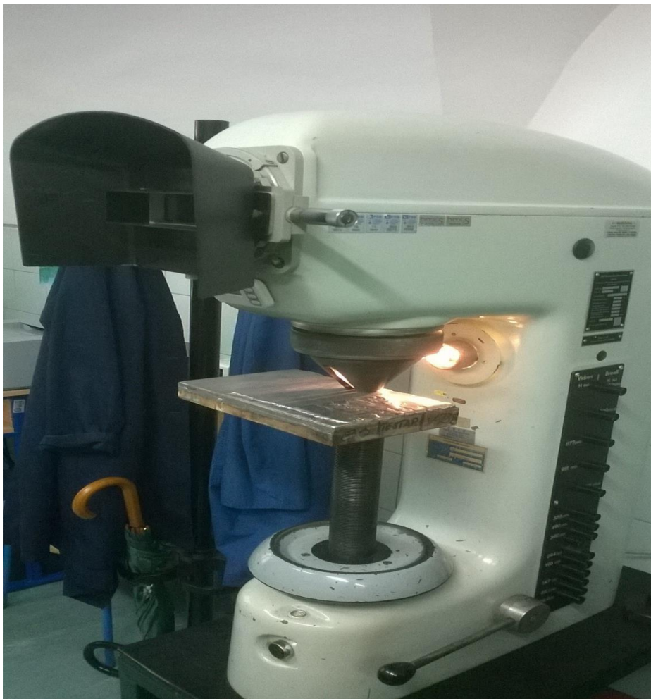
Slika 19. Tvrdomjer BRINELL-VICKERS na kojemu su provedena ispitivanja
