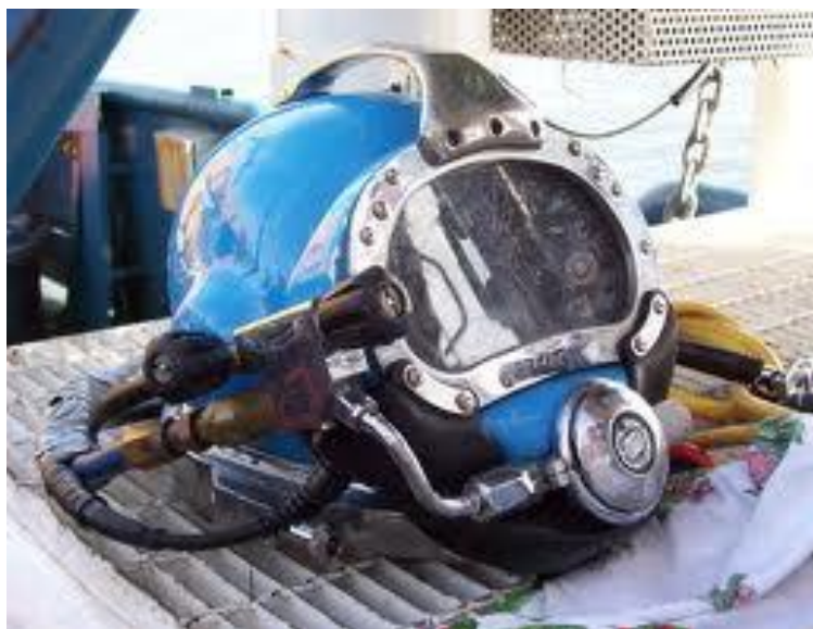
SLIKA 15. maska za cijelo lice s tempiranim staklom
