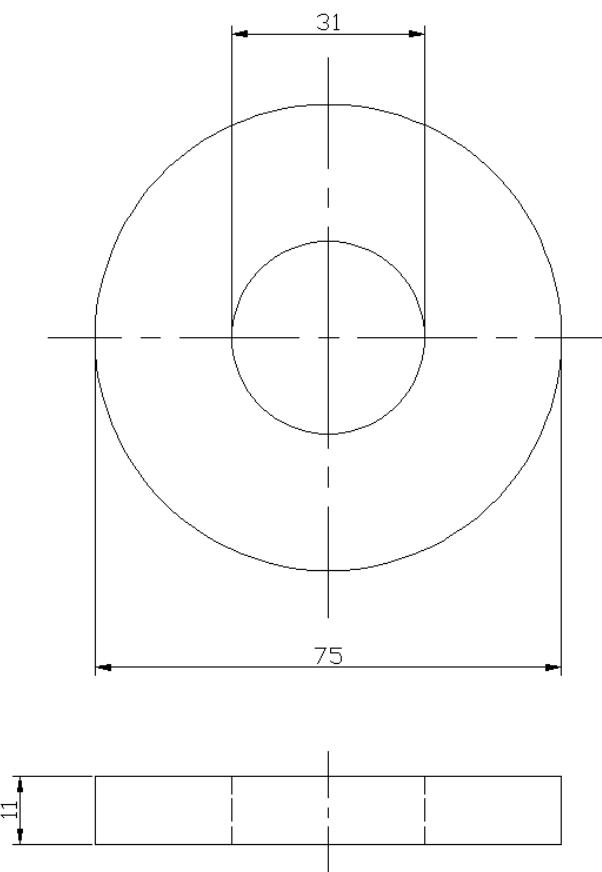
Slika 28. Nacrt permanentnog magneta torusnog oblika. Izvorno autor.
