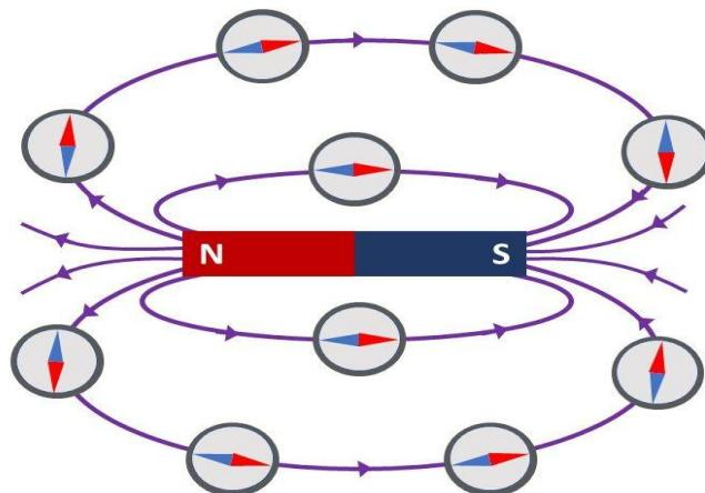
**Slika 6.** Predodžba magnetskog polja permanentnog magneta [3].
