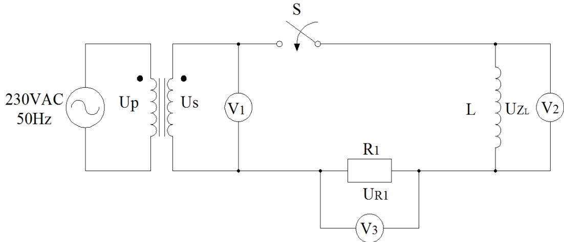
**Slika 36.** Shema izmjeničnog RL strujnog kruga. Izvorno autor.
