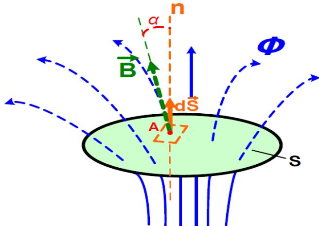
Slika 9. Predodžba nehomogenog magnetskog polja [5].
