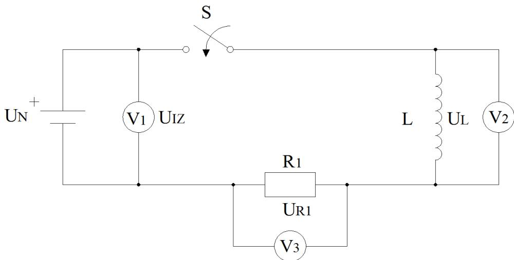
**Slika 33.** Shema istosmjernog RL strujnog kruga. Izvorno autor.
