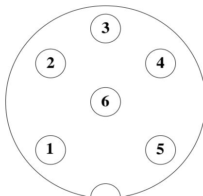
**Slika 26.** Predodžba konektora za priključak Hallove sonde [8].
