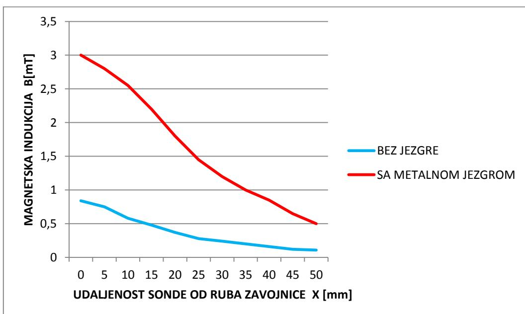
**Slika 34.** Dijagram magnetske indukcije zavojnice ( $U_N = 5V$ )
