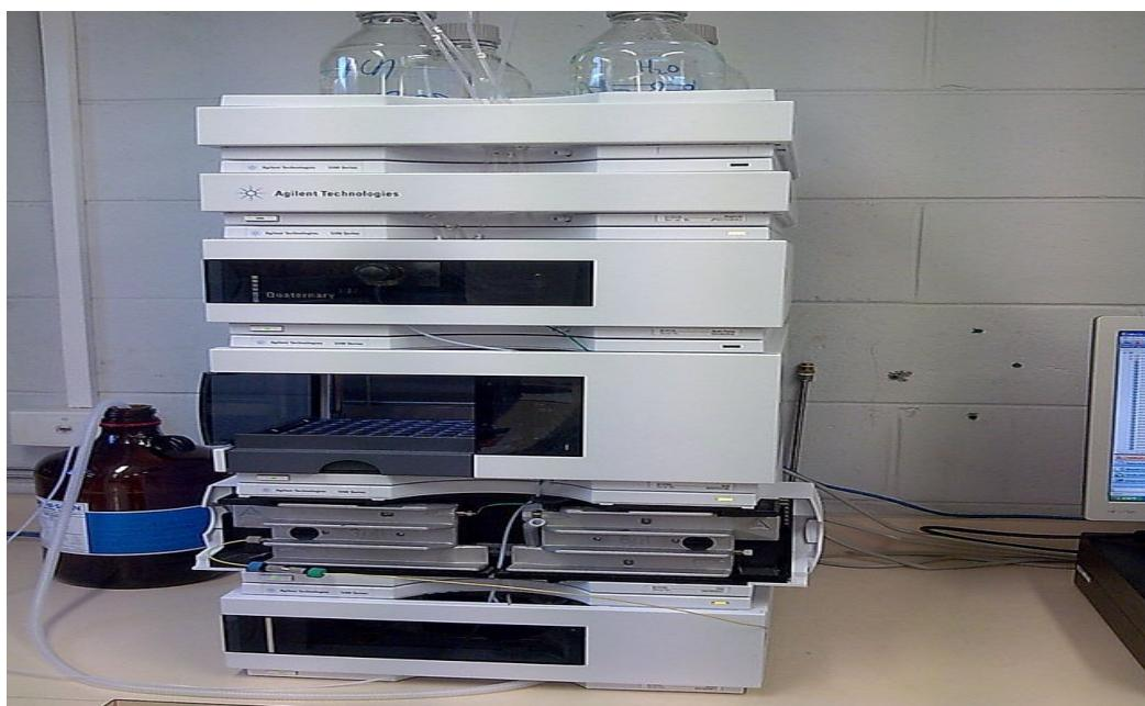
Slika 10. Suvremeni uređaj za tekućinsku kromatografiju visoke djelotvornosti
