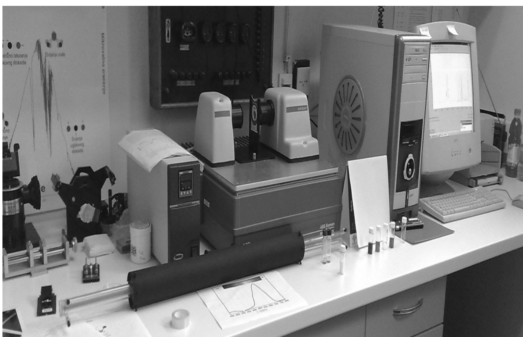
Slika 12. Spektrometar apsorpcije infracrvenog zračenja (IRB, Zagreb)
