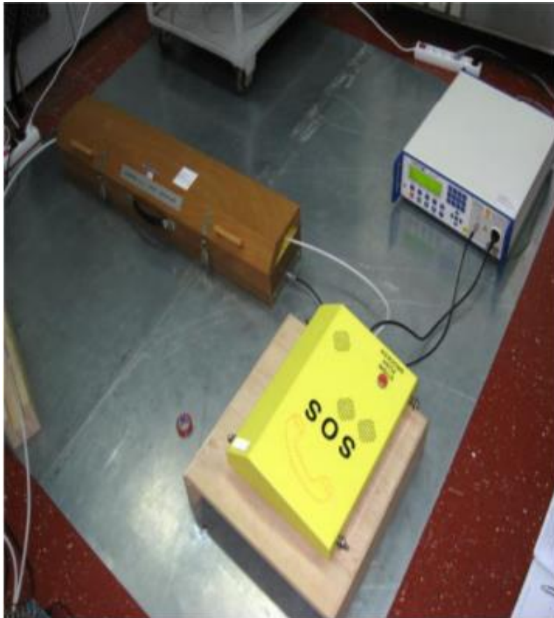
Slika 11. Predodžba ispitivanja otpornosti na brze tranzijante [33].
