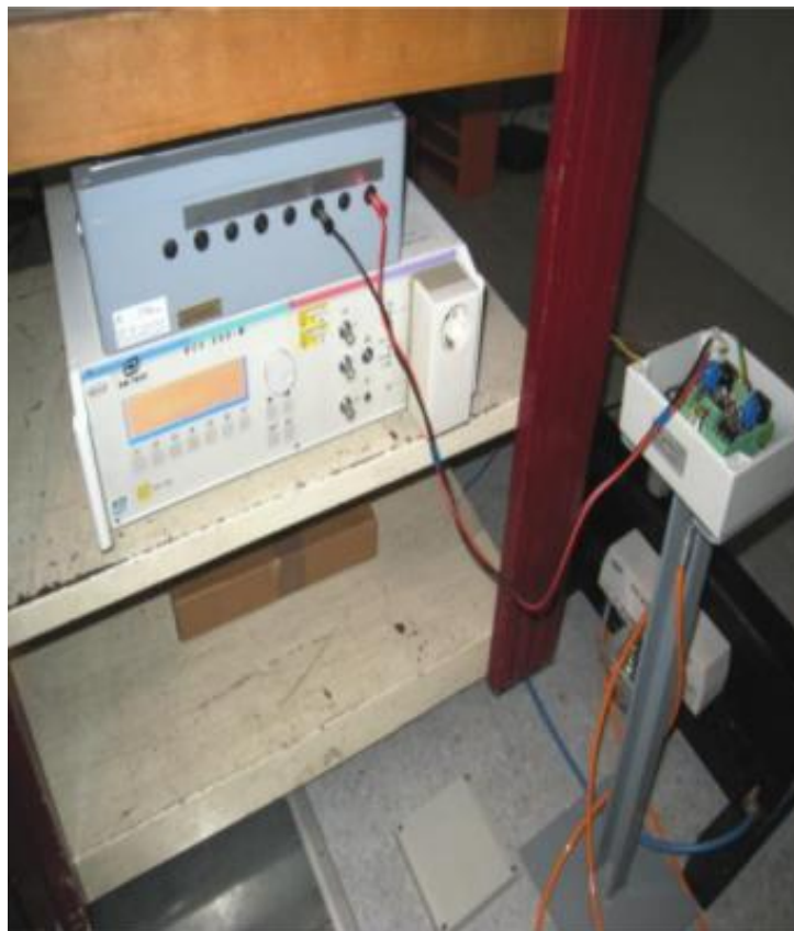
Slika 12. Predodžba ispitivanja otpornosti na udarne prenapone [34].
