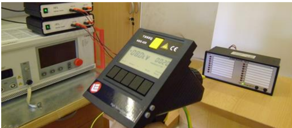
Slika 6. Predodžba EMC ispitivanja otpornosti na elektronsko pražnjenje [28].
