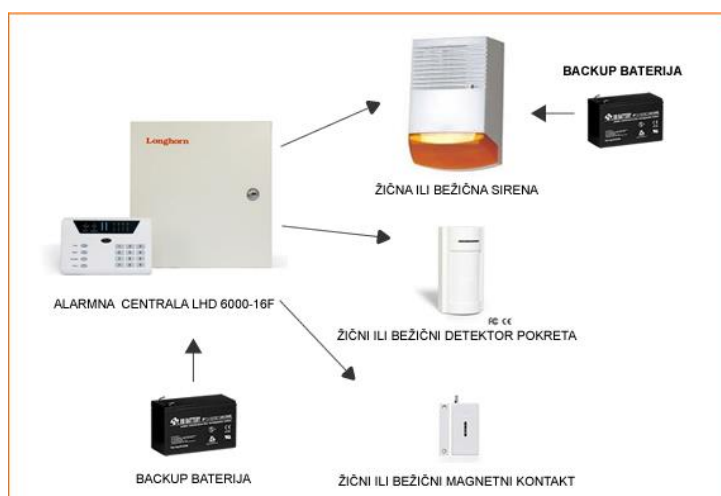
Slika 1. Predodžba alarmnih sustava [23].
