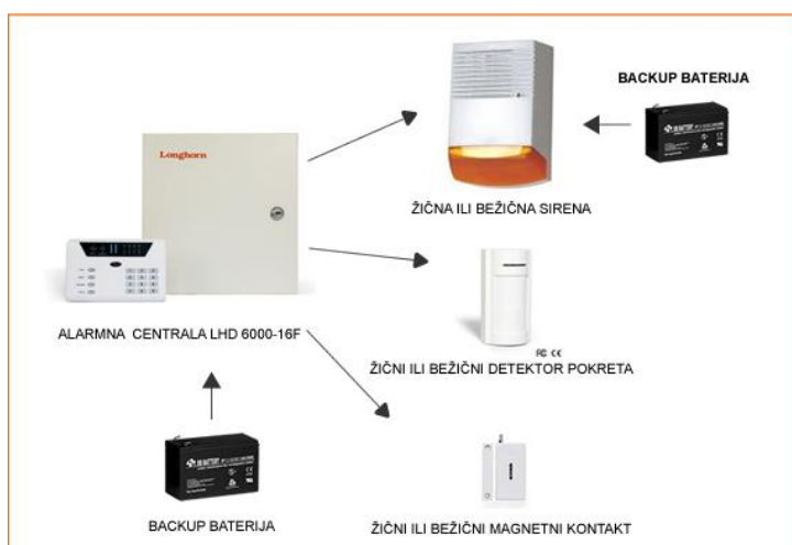
Slika 1. Predodžba alarmnih sustava [23].
