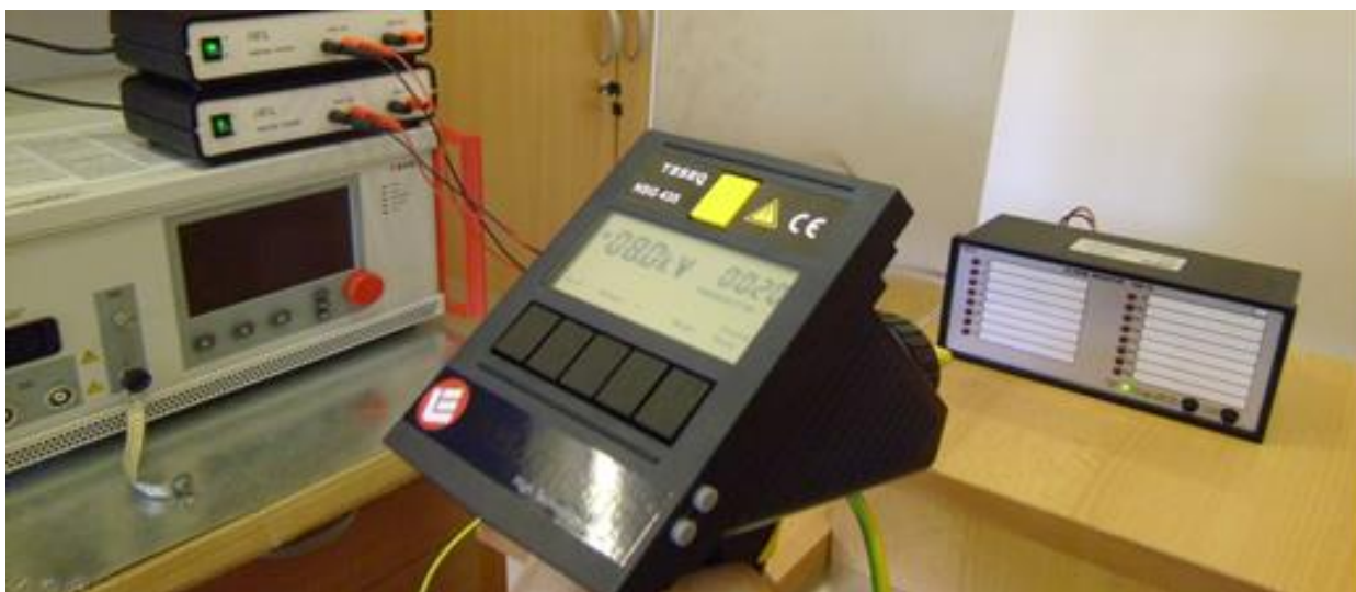
Slika 6. Predodžba EMC ispitivanja otpornosti na elektronsko pražnjenje [28].
