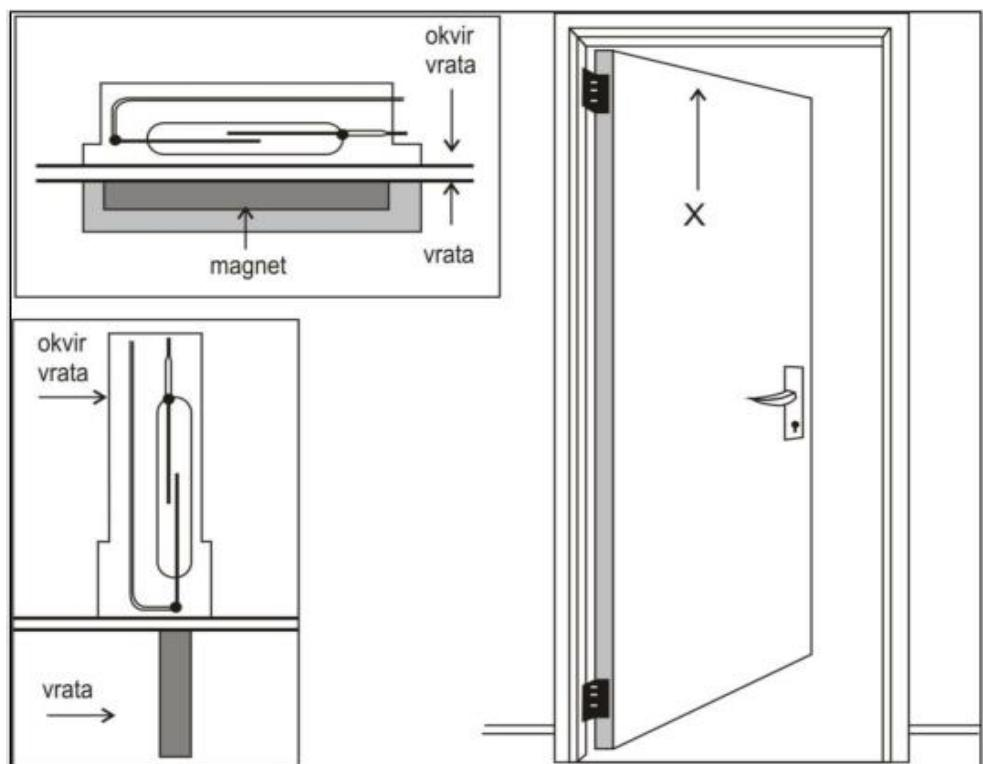
Slika 2: Predodžba magnetnog kontakta na vratima [19]
