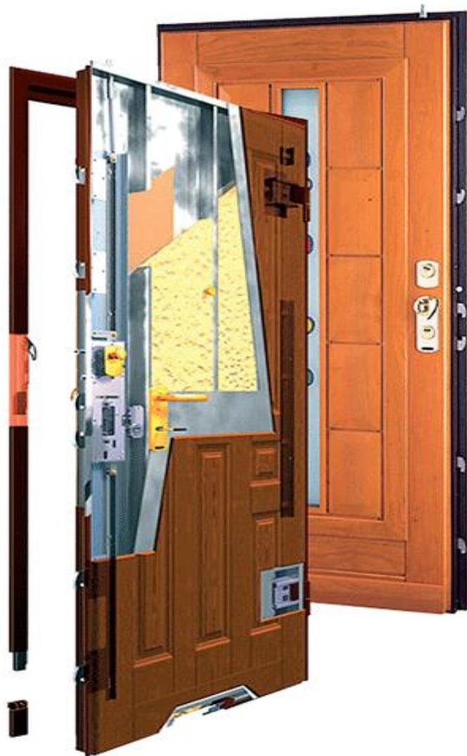
Slika 17: Predodžba protuprovalnih vrata [31]
