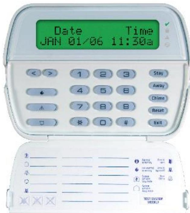
Slika 13: Predodžba tipkovnice alarmne centrale [28]
