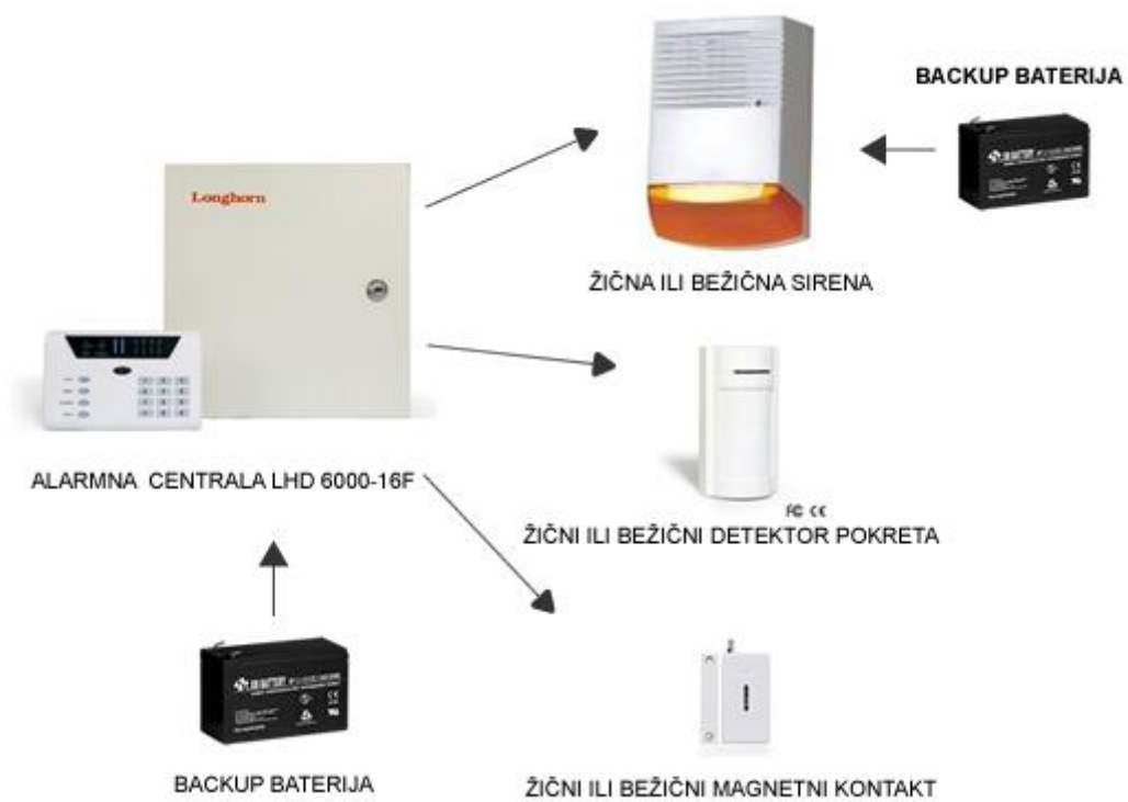
Slika 10: Predodžba alarmne centrala i elemenata [26]
