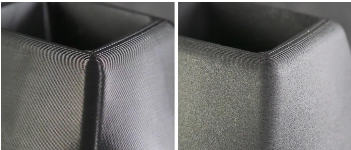
Slika 55. Površina prije i nakon sačmarenja [41]
