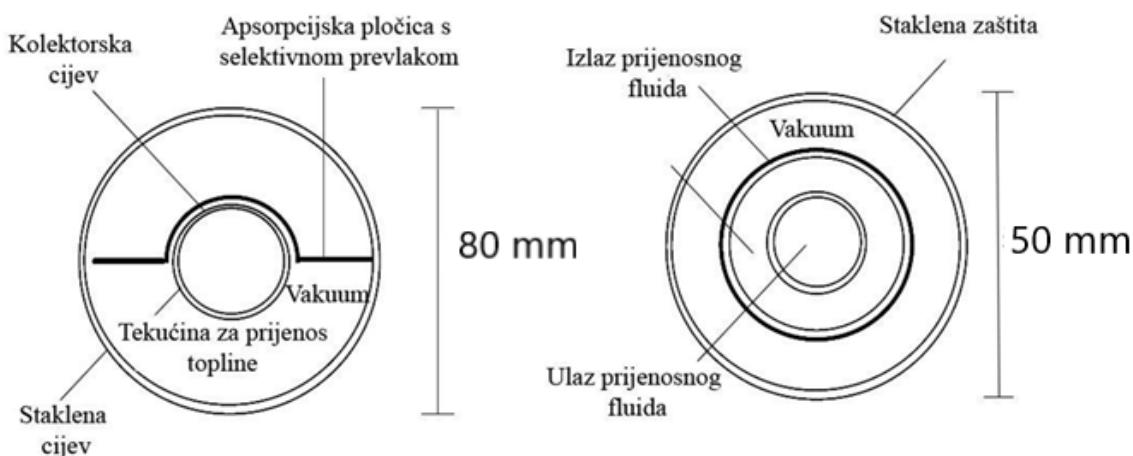
Slika 2. Presjek apsorbera vakuumskog kolektora [autor izvorno]
