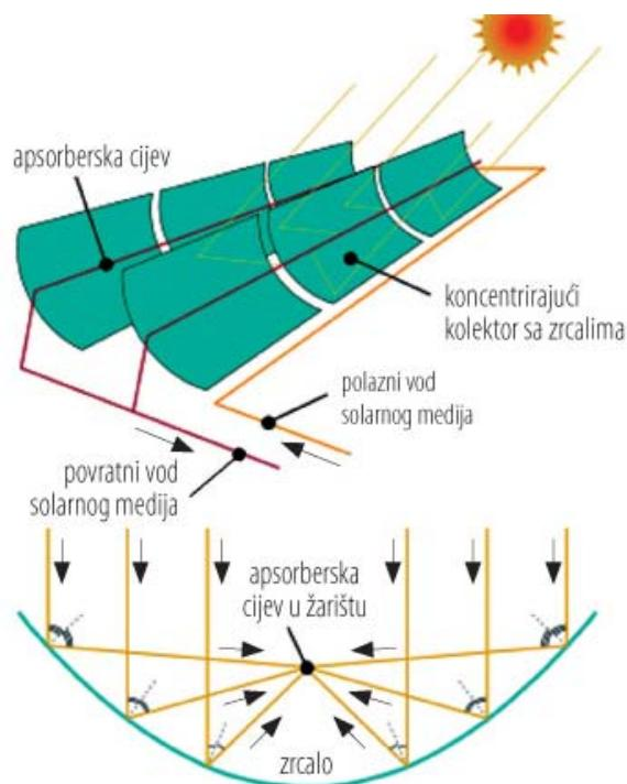
Slika 6. Pojednostavljeni prikaz Paraboličnih solarnih sustava [4]
