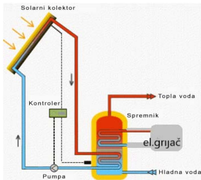
Slika 20. Implementacija solarnih kolektora na privatnoj kući [10]
