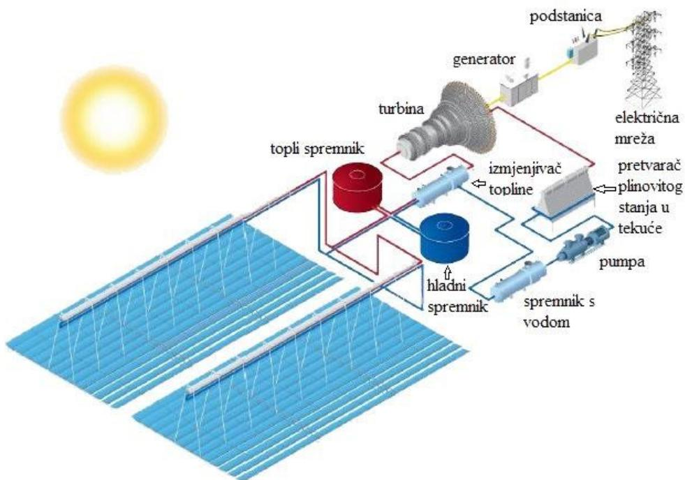
Slika 8. Shematski princip rada Fresnelovih solarnih sustava [5]
