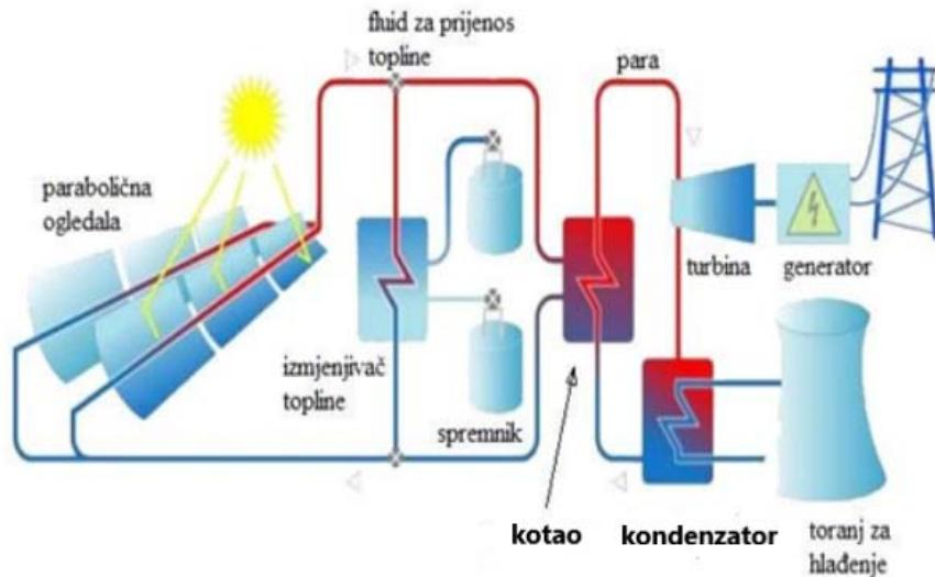
Slika 7. Shema dobivanja el. energije pomoću paraboličnih kolektora [5]
