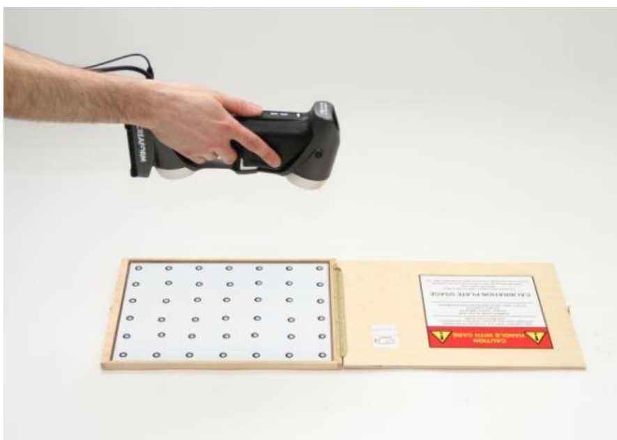
Slika 13. Kalibracijska ploča za Creaform HandySCAN 3D [7]
