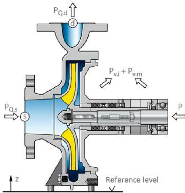
**Slika 8. Ulazne i izlazne snage pumpe [8]**
