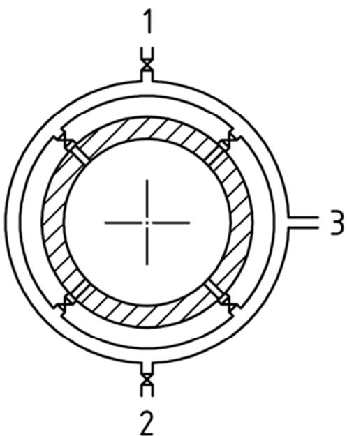
Slika 2. Priključci za mjerenje tlaka,
