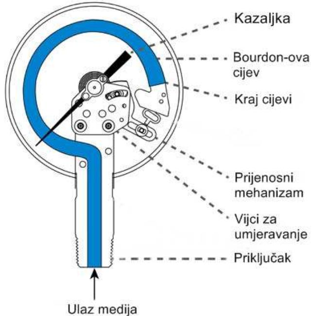
Slika 7. Dijelovi opružnog manometra [7]
