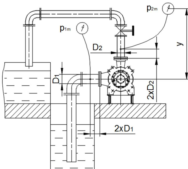
**Slika 21. Shema ispitivanja, bokocrt [i.a.]**
