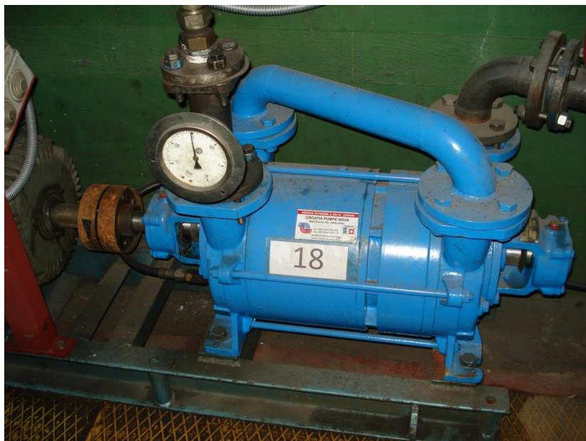
Slika 28. Vakuum-pumpa [i.a.]
