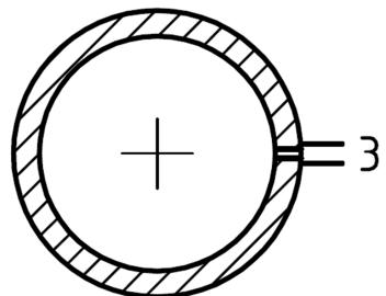
Slika 3. Priključak za mjerenje
