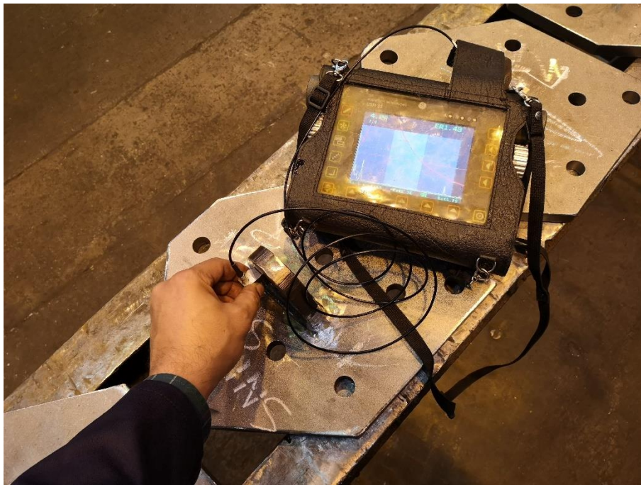
Slika 2. Ispitivanje zavora ultrazvučnom metodom. 2 [2]
