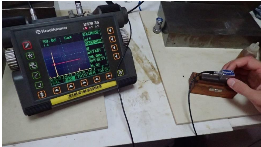
Slika 49. Kalibracija mjernog područja na kalibracijskom bloku V2. [2]
