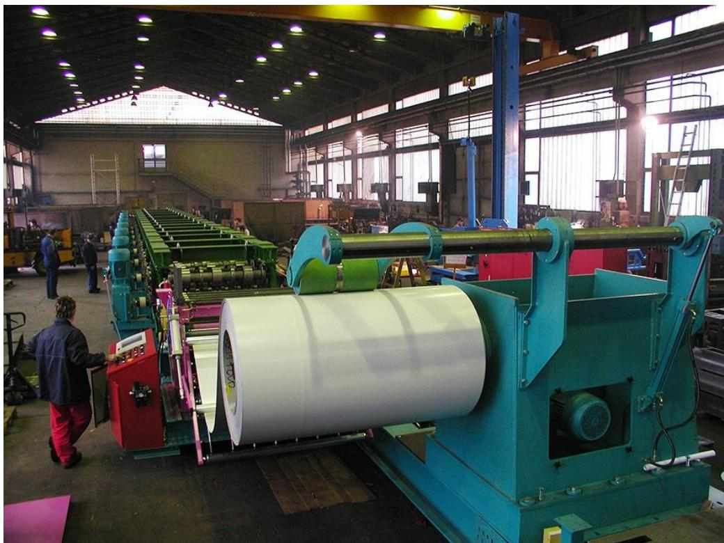
Slika 1.7 Stroj za profiliranje limova i traka [4]
