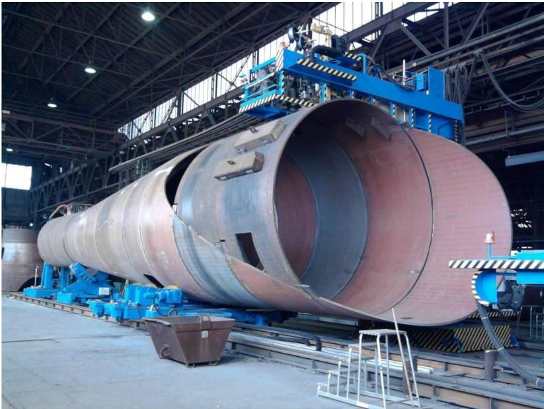
Slika 1.6 Portal za zavarivanje cijevi vjetroelektrane [4]
