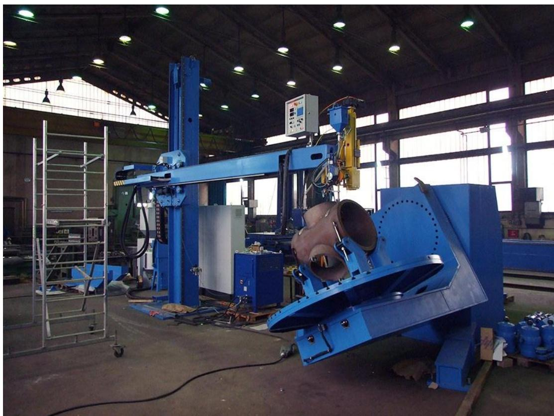
Slika 1.3 Stup za zavarivanje i pozicioner [4]
