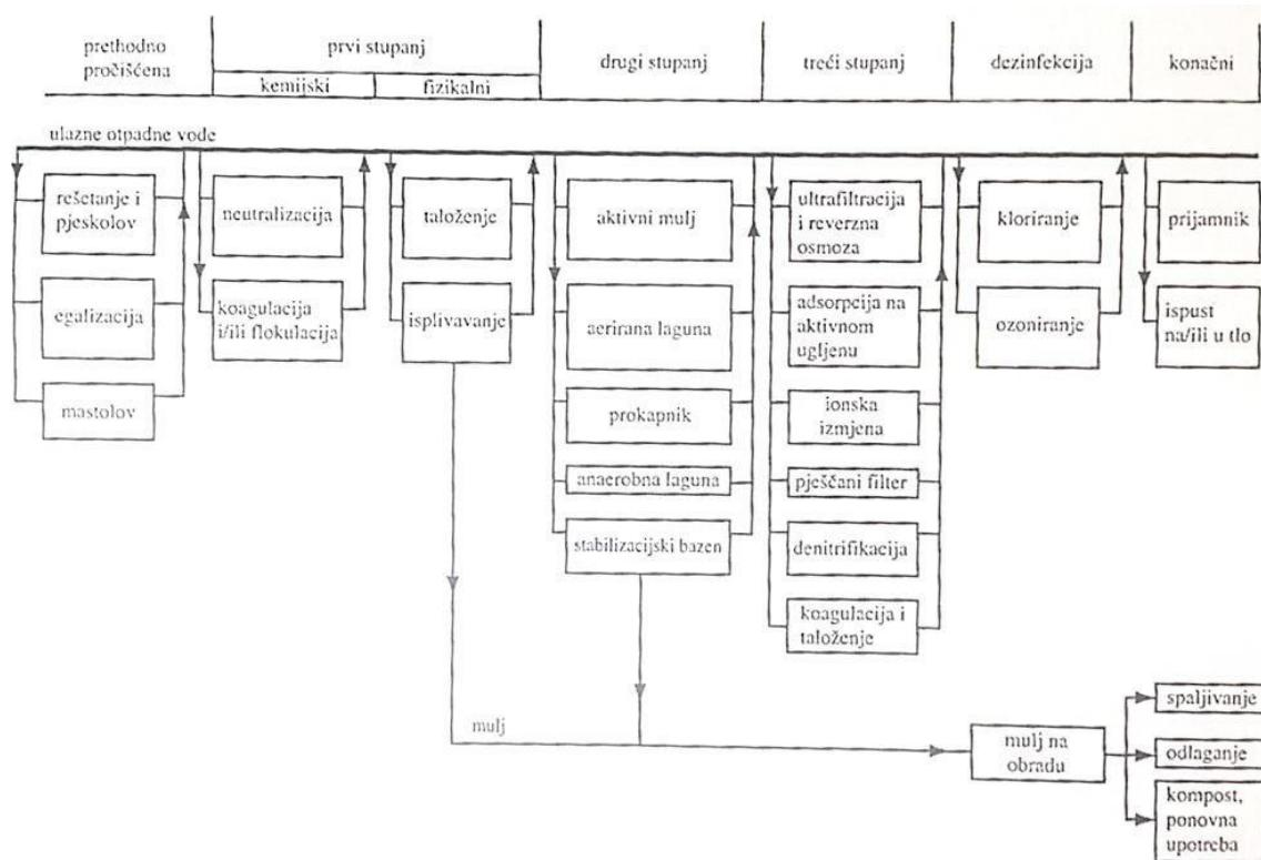
**Slika 4. Dijelovi tehnološke linije pročišćavanja otpadnih voda [4]**
