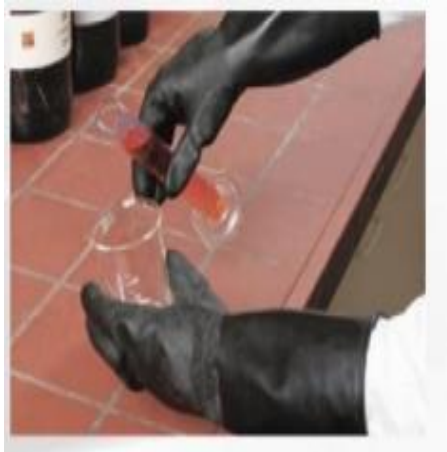
Sl. 11. Rukavice za zaštitu od radioaktivne kontaminacije[10]
