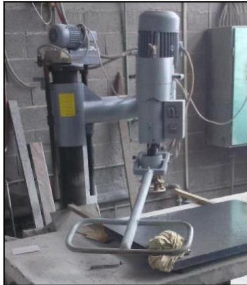
Slika 10. Stroj za brušenje kamena
