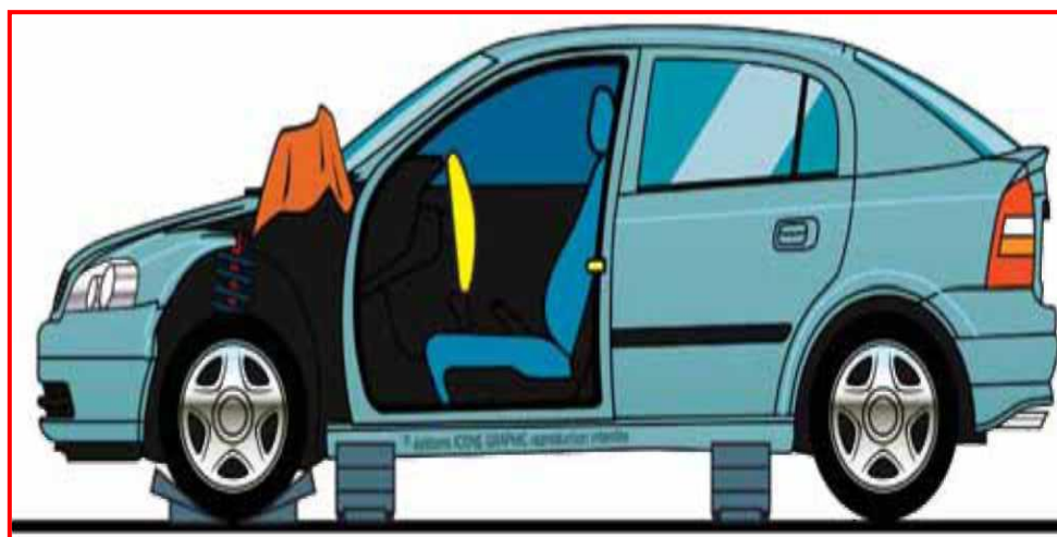
Slika 26. Uklanjanje vrata sa vozila.[1]
