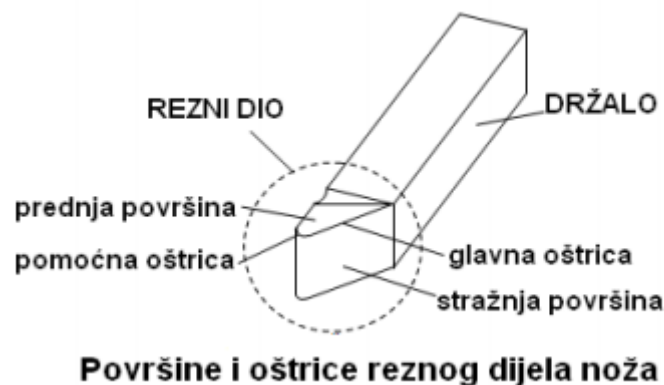
Slika 14. Elementi reznog alata. [11]
