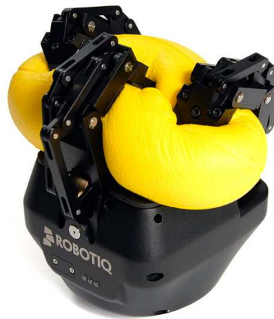
Slika 13: Prihvatnica s 3 čeljusti - hvatanje mekog predmeta [19]
