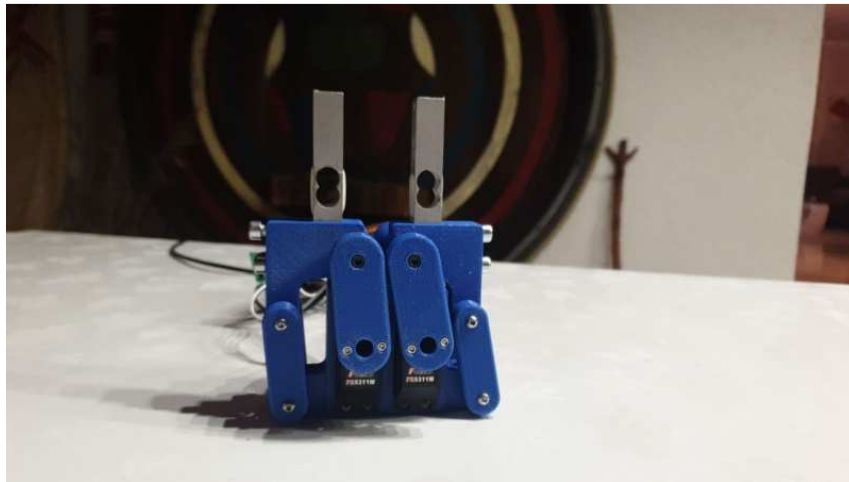
Slika 31: Sklopljena prihvatnica u zatvorenom položaju
