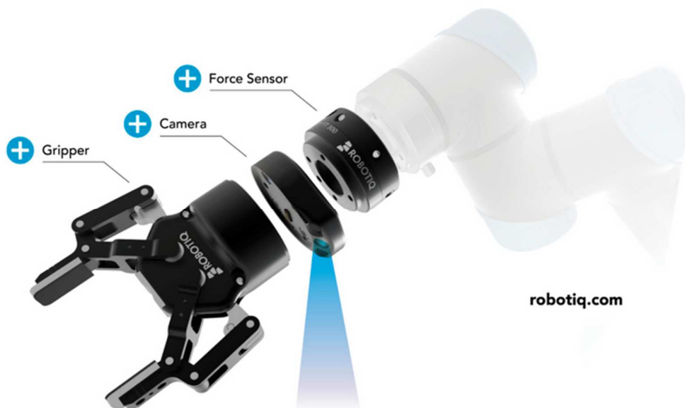
Slika 6: Robotska prihvatnica sa senzorima [16]
