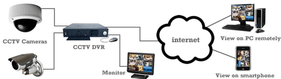
Slika 23. Blok dijagram povezivanja uređaja u CCTV sustavu videonadzora
