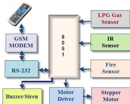
Slika 29. Blok dijagram alarmnog sustava baziran na GSM modulu
