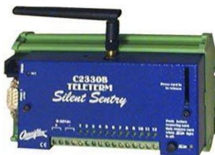
Slika 28. GSM alarm modul
