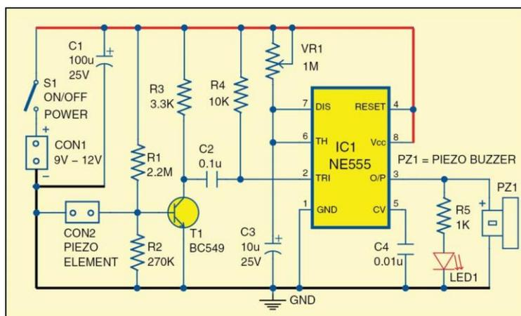
Slika 20. Elektronička shema detektora loma stakla
