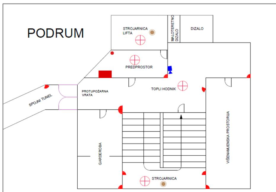
Slika 32. Skica tlocrta podruma sa rasporedom elemenata tehničke zaštite
