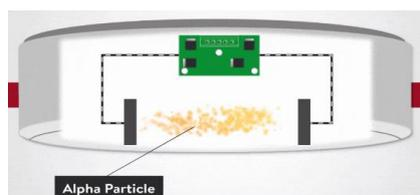
Slika 5. Predodžba unutrašnjosti ionizirajućeg detektora dima
