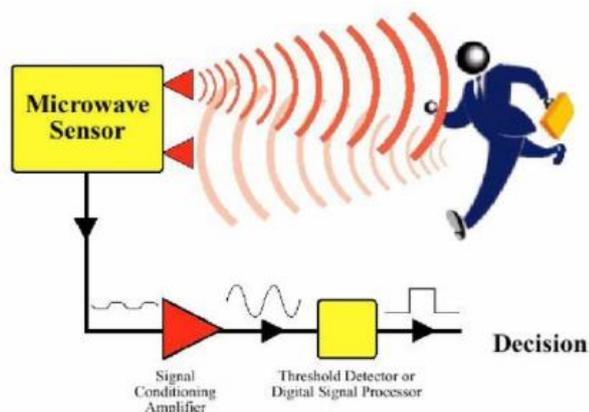
Slika 17. Blok dijagram rada mikrovalnog detektora pokreta
