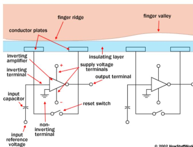
Slika 15. Predodžba rada kapacitivnog skenera otiska prsta
