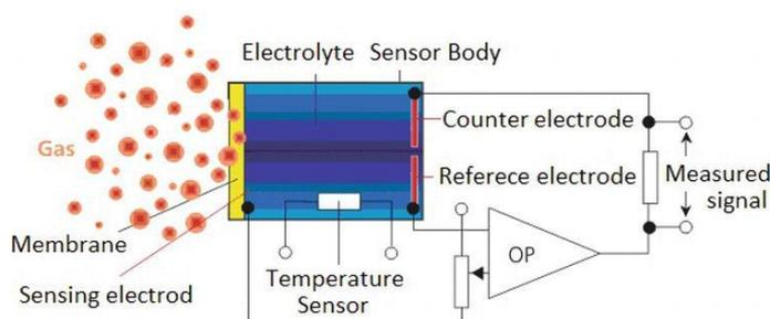
Slika 8. Predodžba elektroničke sheme elektrokemijskog detektora plina
