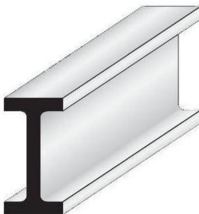
Slika 14. Čelični profil s usporednim pojasnicama [13]
