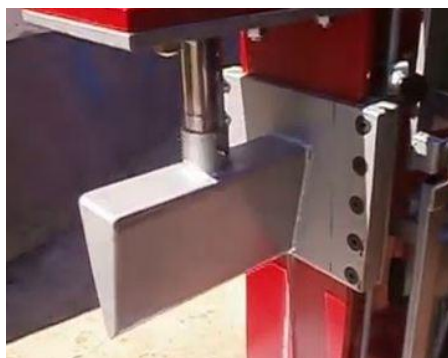
Slika 10. Prikaz najčešće izvedbe pomične sjekire [9]
