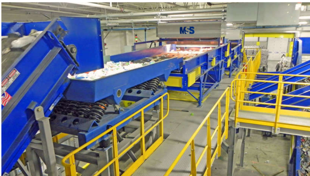
Slika 9. Optičko sortiranje otpada 51
