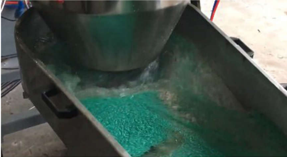
Slika 11. Pranje granulata komunalnog otpada 53
