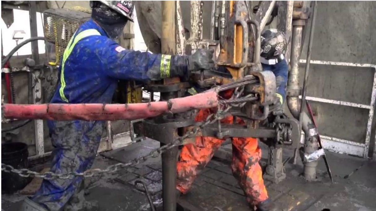
Slika 41. Dvoje radnika prilikom spajanja bušaćih šipki na radnom podištu
