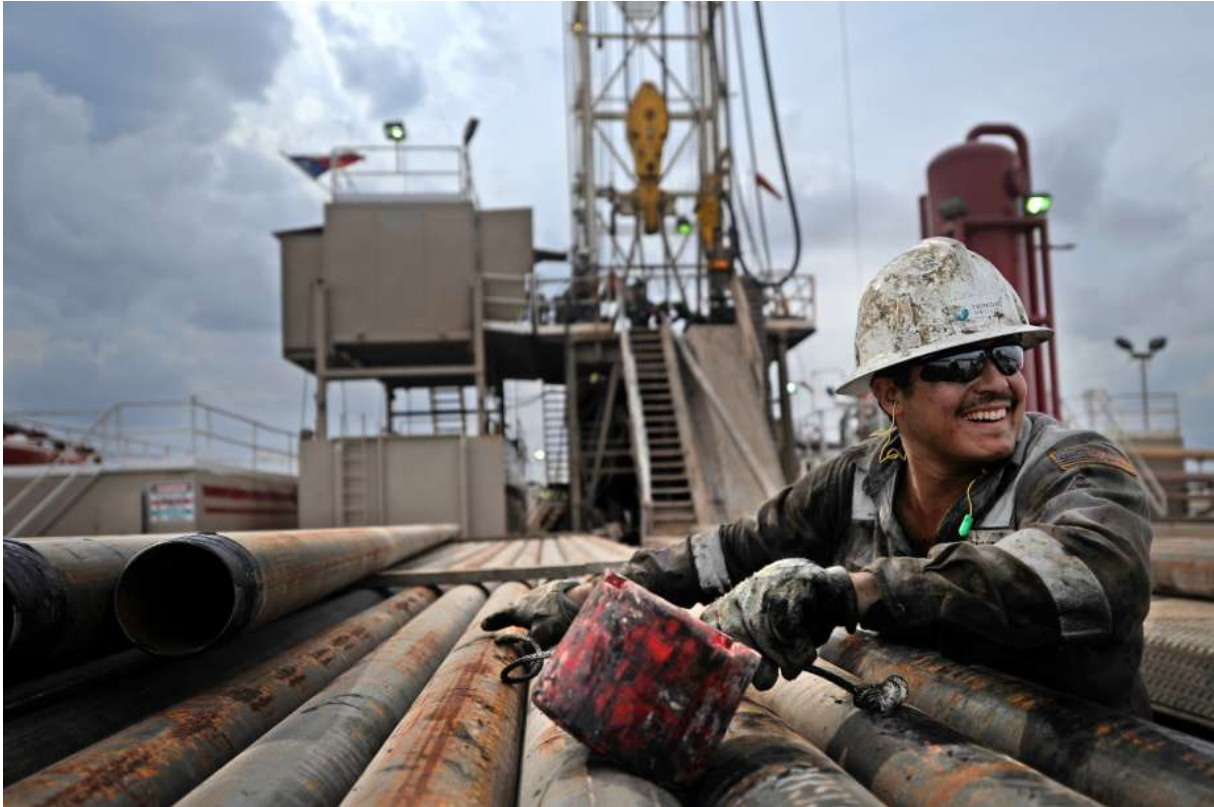
Slika 43. Pripremanje šipki za uvlačenje u toranj
