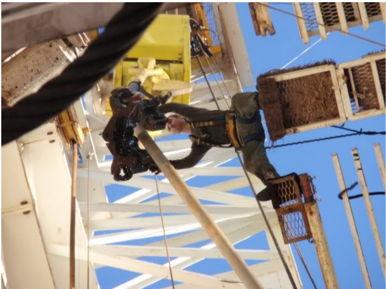
Slika 40. Tornjaš ubacuje šipku u elevator
