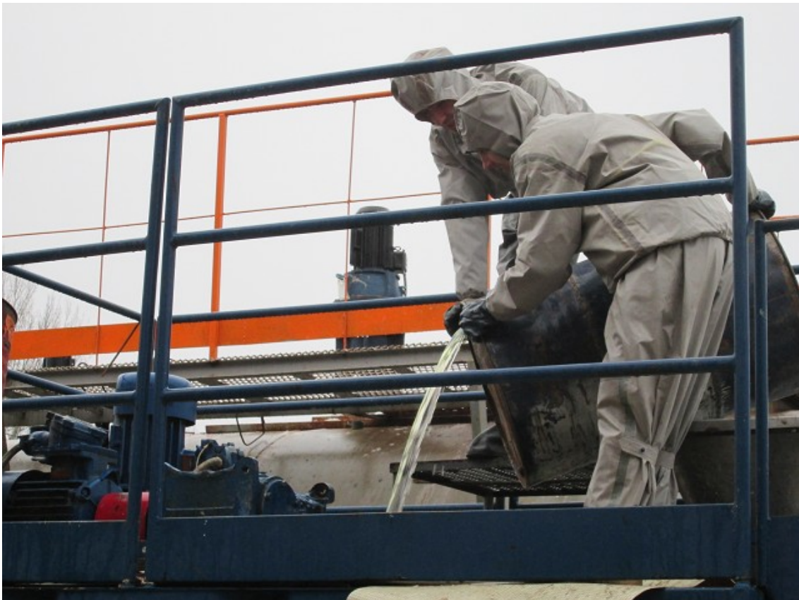
Slika 10. Dodavanje kemikalije u isplaku na bušačem postrojenju
