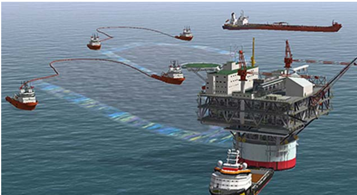
Slika 17. Prikaz sanacije i sprečavanja daljeg širenja zagađenja mora naftom sa platforme
