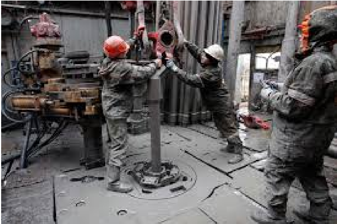
Slika 42. Dvoje radnika spajaju šipke, dok treći radnik čeka da ih zavrne hidrauličkim navrtaćem
