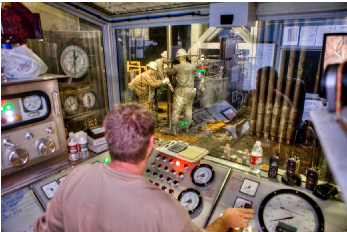
Slika 39. Vođa smjene nagleda i vrši rukovanje dizalicom iz bušaće kućice
