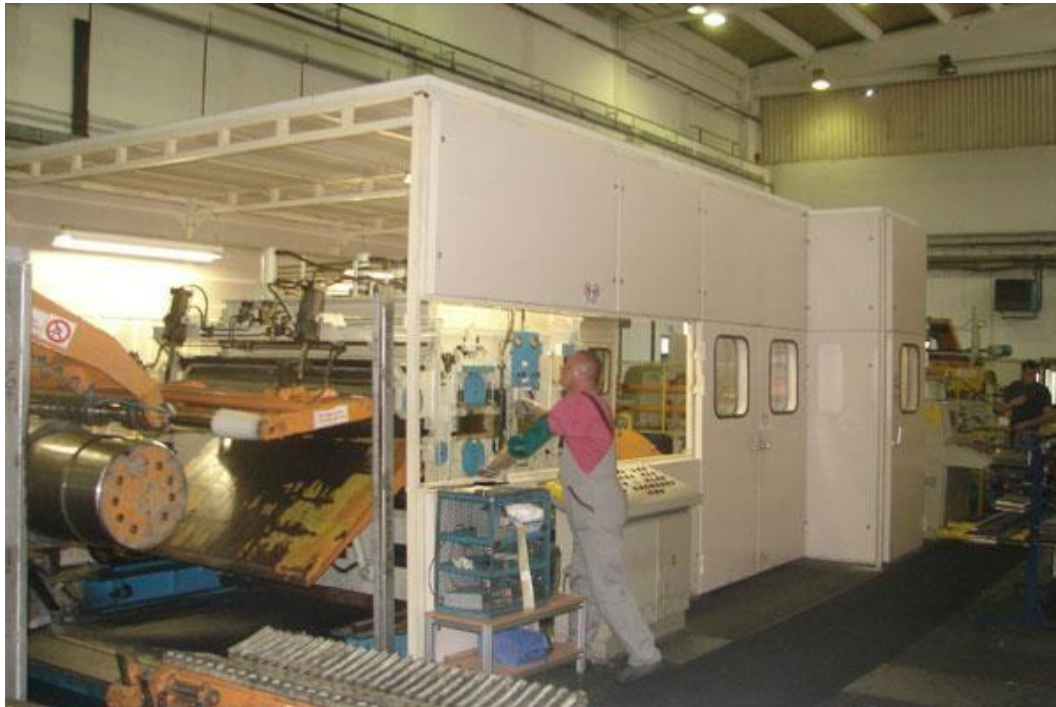
Slika 10. Primjer ograđenog stroja
