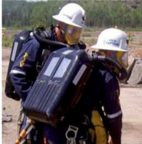
Slika 23 Aparat sa zatvorenim sustavom cirkulacije
