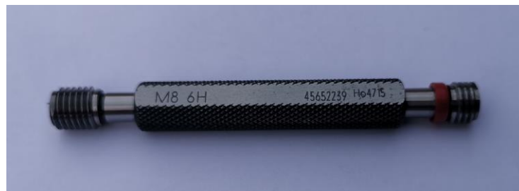
Slika 31. Kontrolni kalibar za M8
