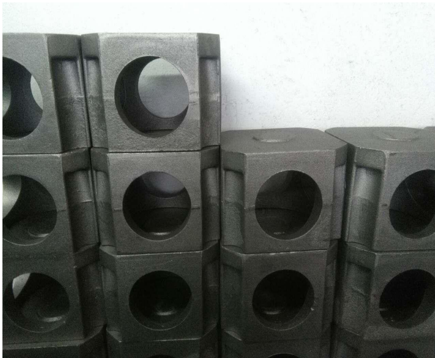
Slika 8. Poluproizvodi – odljevci sivog lijeva
