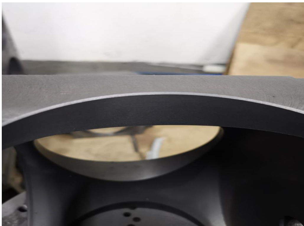
Slika 39. Prikaz kvalitetne površine kod istokarivanja
