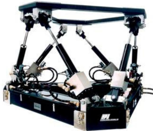
*Slika 2-6. Primjer paralelnog manipulatora sa 6-DOF*
