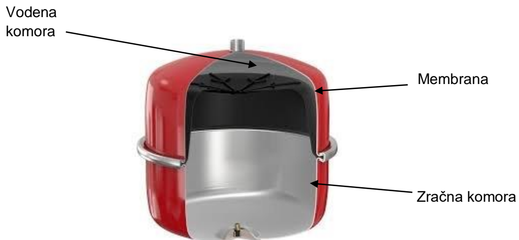
Slika 25. Ekspanzijska posuda u presjeku [30]
