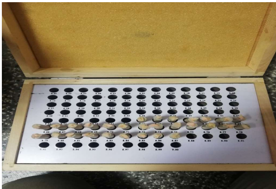
Slika 14. Razvrstavanja kalibara za provrte
