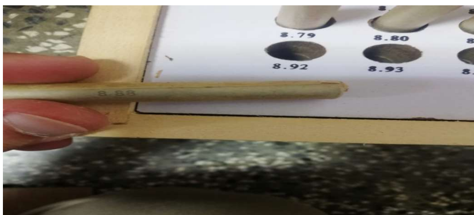
Slika 15. Primjer označavanja jednog kalibra
