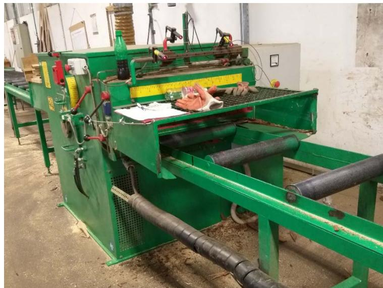
Slika 9. Kružna pila za uzdužan rez
