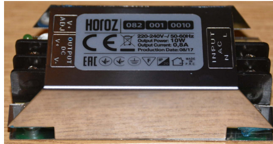
Slika 35. LED driver s mogućnošću podešavanja izlaznog napona
