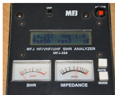
Slika 40. Provjera ispravnosti antene - MFJ-269
