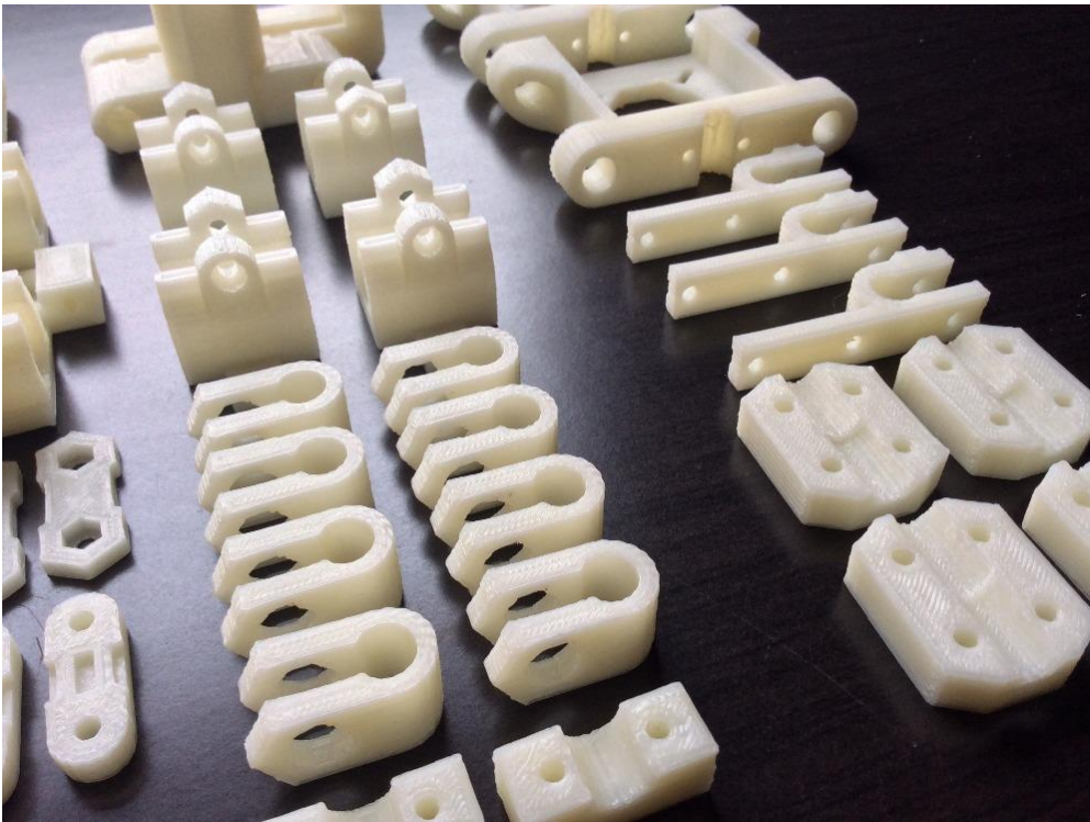
Slika 9. Primjeri modela izrađenih FDM postupkom [8]
