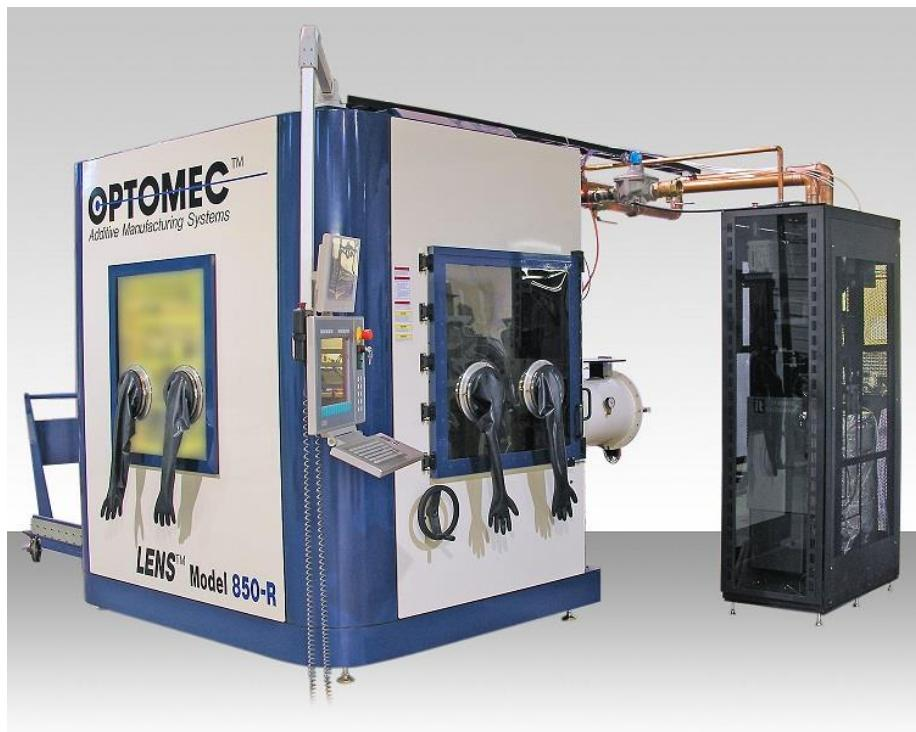
Slika 15. Stroj za izradu LENS postupkom [14]
