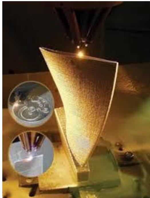
Slika 14. Primjer proizvoda načinjenog LENS postupkom [13]
