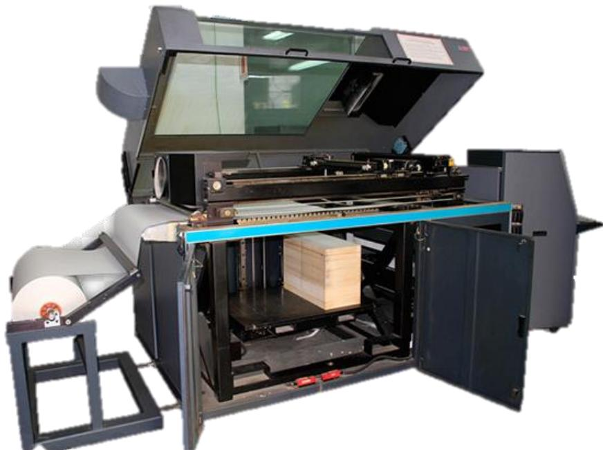
**Slika 11. Uredaj za izradu modela LOM postupkom [10]**
