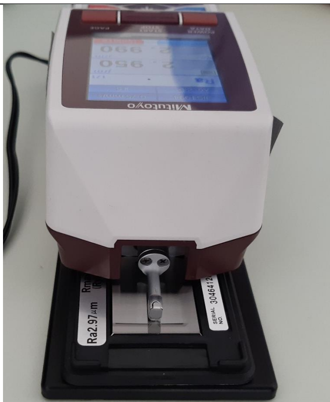
Slika 25. Prikaz kalibriranja pomoću etalona
