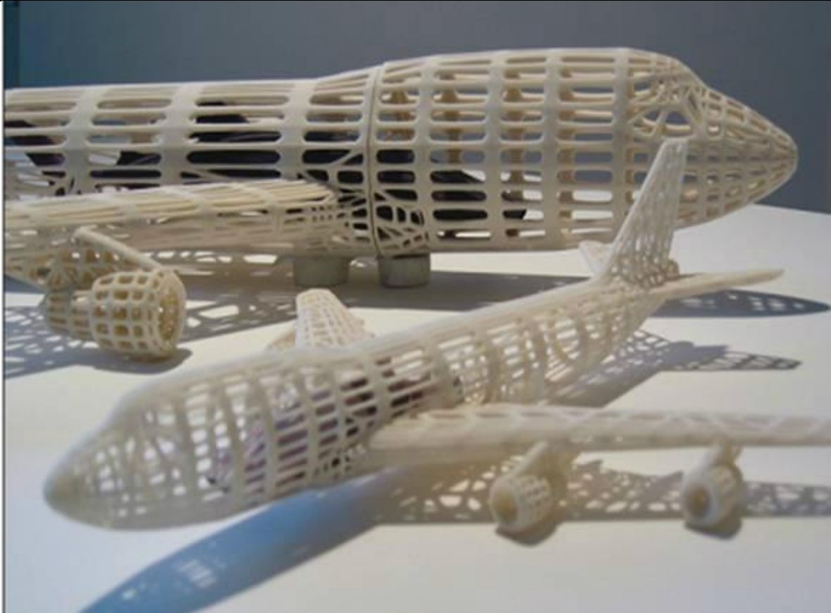
Slika 19. Primjer proizvoda SLS postupka [18]
