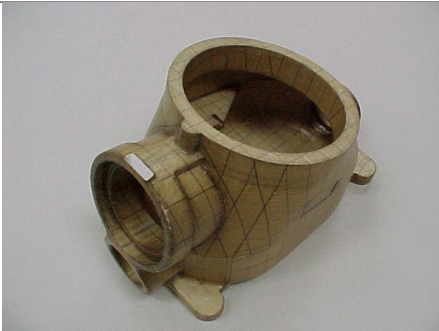
Slika 12. Primjer proizvoda načinjenog LOM postupkom [11]
