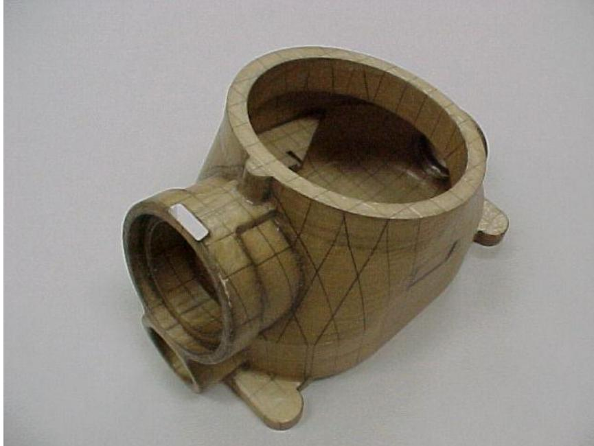
Slika 12. Primjer proizvoda načinjenog LOM postupkom [11]
