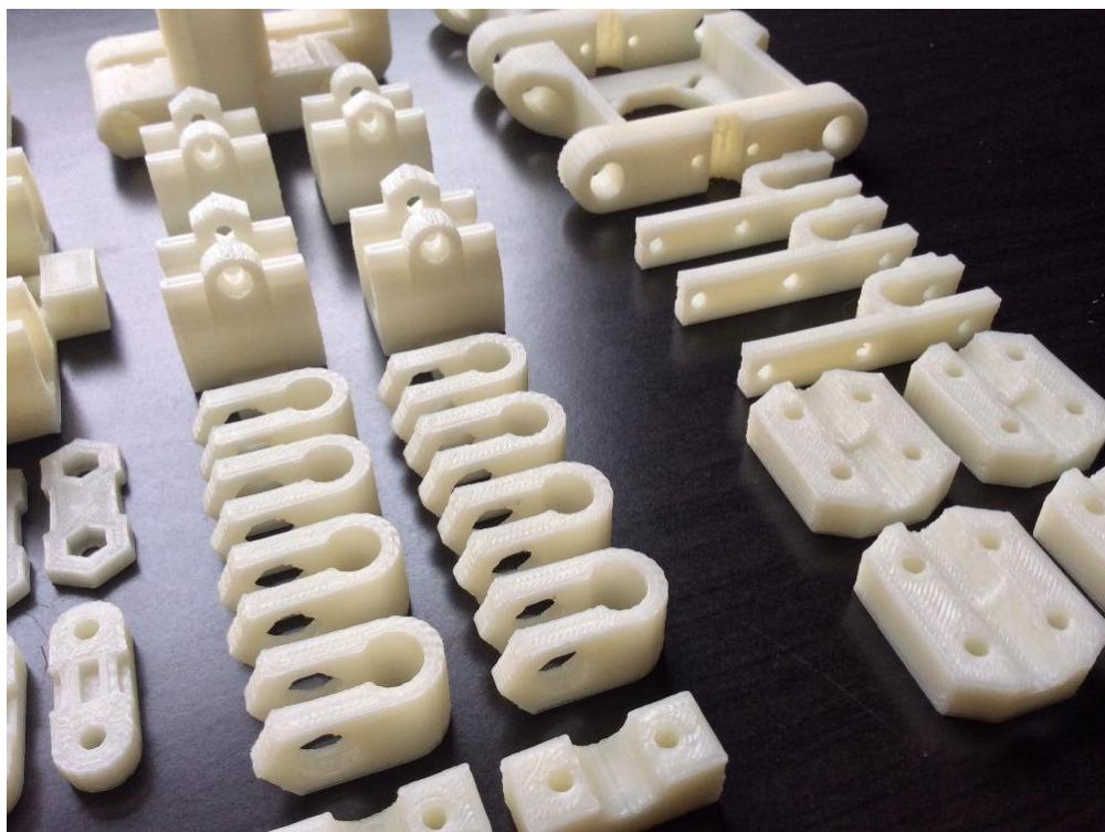
Slika 9. Primjeri modela izrađenih FDM postupkom [8]
