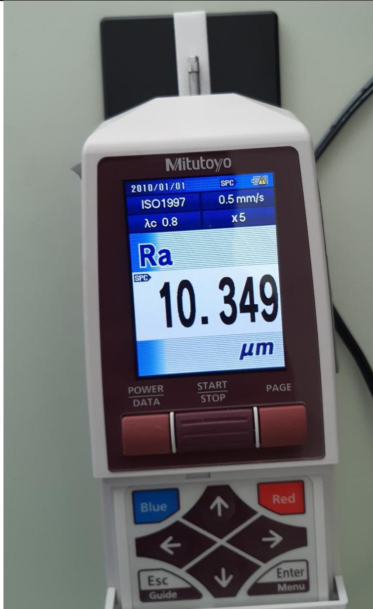
Slika 27. Prikaz mjerena epruvete, i dobivene vrijednosti parametra  $R_a$
