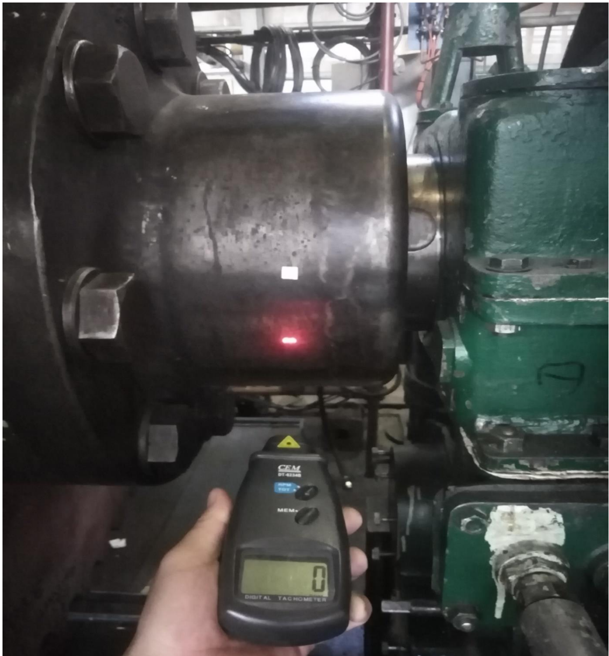
Slika 38. Predodžba mjerenja broja okretaja motora **
