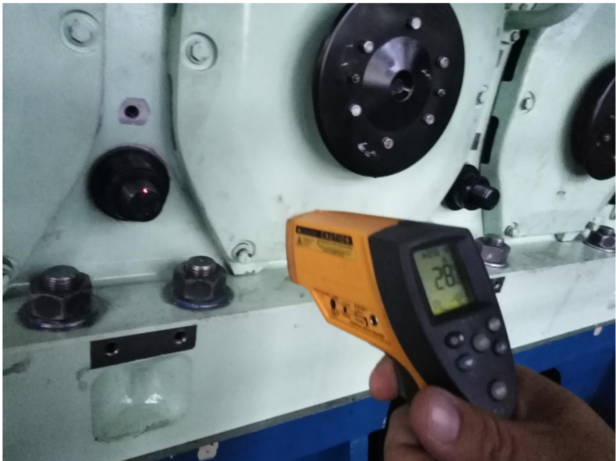
Slika 36. Predodžba mjerenja temperature temeljnih ležajeva tijekom ispitivanja **
